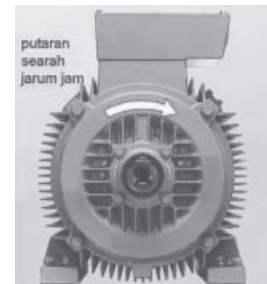
Gambar 5.12 Putaran motor dilihat dari sisi poros
